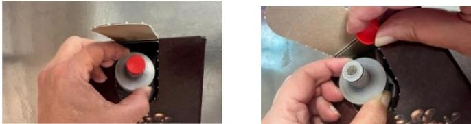
Ziehen Sie am CMB-Anschluss den äußeren Ring nach oben und drücken Sie ihn auf den BiB-Verbinder, bis er richtig eingerastet ist.
