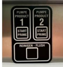
4. Drücken Sie die untere Taste **'Reinigen - Flush'**. Im Display erscheint die Frage **,Heißwasser in Kuhlscr., drück. ←'**
