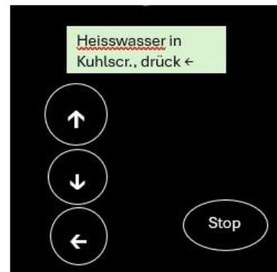
5. Die **←Taste (enter)** links von der Stop Taste drücken. Die Maschine startet den halbautomatischen Reinigungszyklus, saugt Heißwasser aus dem Tank und klappert dabei einmal die Ausgabeventile ab. Die Maschine führt dann die Reinigungsfunktion automatisch aus – **nicht unterbrechen!** Sobald die Reinigungsfunktion abgeschlossen ist, blinken die Lämpchen nicht mehr, sondern leuchten permanent.
